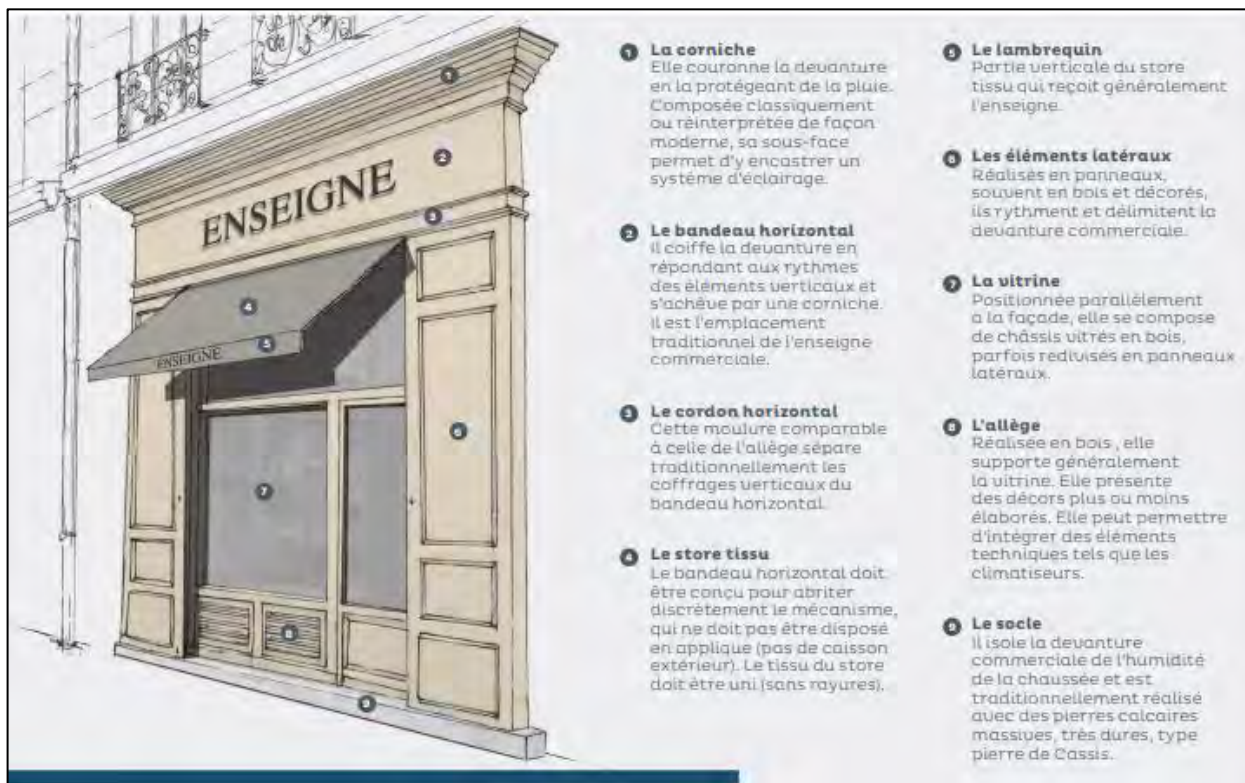
Exemple d'une devanture commerciale (source CAUE 13)
